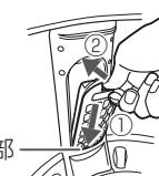
糸くずフィルター下の凸部を洗濯・脱水槽内に差し込んでから①全体を押し込む②
