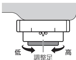
**2** ピンをはずして矢印方向にロックナットを回して固定する
