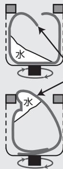
洗濯・脱水槽が回転しても水が防水性の衣類や繊維製品から抜けないため、水が片寄って大振動を引き起こす
