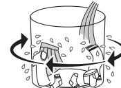
洗濯・脱水槽をゆっくり回し、給水と排水を同時にに行います。
