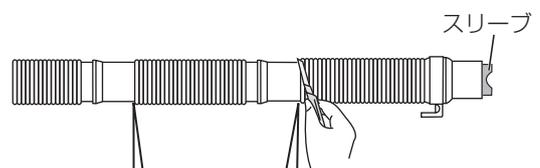
本体と排水口の距離に応じて、2カ所のうち、どちらかを切って先端にスリーブをはめ直してください。
