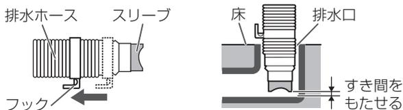
排水ホースは、排水時の水の力や振動などで動く場合がありますので、排水口にしっかり差し込み抜けにくいことを確認してください。
