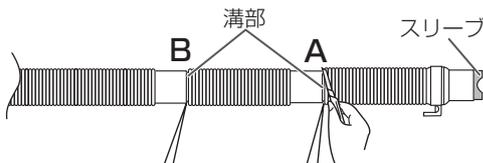
本体と排水口の距離に応じて、溝部2カ所A・Bのうち、どちらかの溝部を切って先端にスリーブをはめ直してください。
