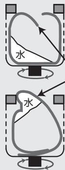
洗濯・脱水槽が回転しても水が防水性の衣類や繊維製品から抜けないため、水が片寄って大振動を引き起こす
