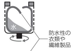
洗濯・脱水槽が高速回転しても水が防水性の衣類や繊維製品から抜けないため、水が上に移動して大振動とともに飛び出る
