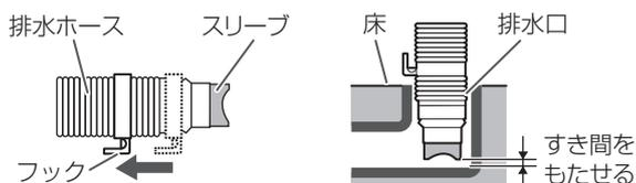
排水ホースは、排水時の水の力や振動などで動く場合がありますので、排水口にしっかり差し込み抜けないことを確認してください。
