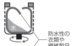
洗濯・脱水槽が高速回転しても水が防水性の衣類や繊維製品から抜けないため、水が上に移動して大振動とともに飛び出る
