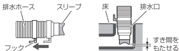
排水ホースは、排水時の水の力や振動などで動く場合がありますので、排水口にしっかり差し込み抜けにくいことを確認してください。
