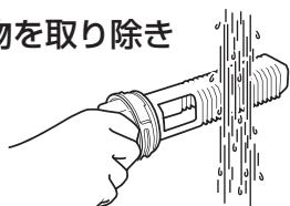
4 排水フィルターを本体へ戻し、ツマミを右(時計回り)に回して、本体と排水フィルターの合印が合うようにしっかりと締める
