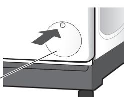
2 排水フィルターのツマミを左(反時計回り)に回し手前に引き出す
