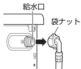
6 袋ナットを傾きのないように確実に締め付ける
