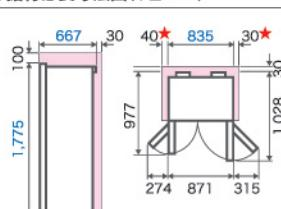
■ 外形寸法: 幅 835 × 奥行 667 × 高さ 1,775mm ■ 質量: 109kg
