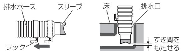
排水ホースは、排水時の水の力や振動などで動く場合がありますので、排水口にしっかり差し込み抜けしないことを確認してください。
