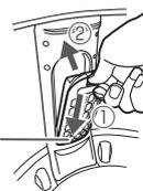
糸くずフィルター下の凸部を洗濯・脱水槽内に差し込んでから(1)全体を押し込む(2)
