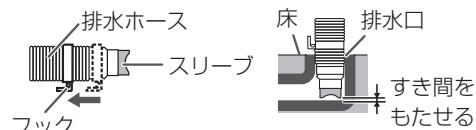
排水ホースは、排水時の水の力や振動などで動く場合がありますので、排水口にしっかりと差し込み抜けないことを確認してください。
