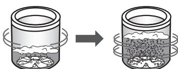
高濃度洗剤液をつくる パルセーター裏の羽根で洗剤を早く溶かし、高濃度洗剤液をつくる
