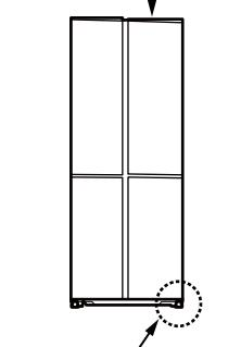
※食品の荷重や設置面の床の強さや材質により、調整後4～5日で扉が下がることがあります。
