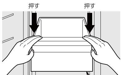
※正しくボックスが取り付けられていると、左右のレール穴にそれぞれボックスの凸部が入りります。
