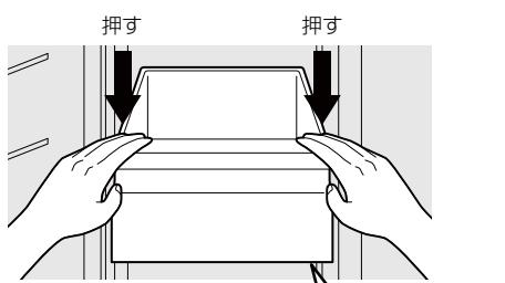
※正しくボックスが取り付けられていると、左右のレール穴にそれぞれボックスの凸部が入りります。
