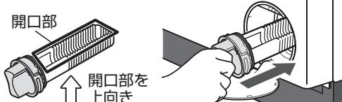
6 ツマミを右(時計回り)に回して、本体と排水フィルターの合印が合うようにしっかりと締める
