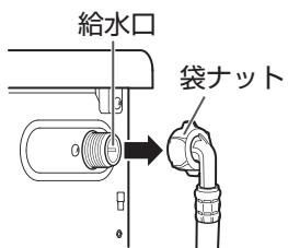
6 袋ナットを傾きないように確実に締め付ける
