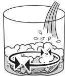
パルセーター裏の羽根で洗剤を早く溶かし、高濃度洗剤液をつくります。
