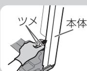
本体の内側から排水口キャップ、排水口リングのツメを強くつまみ、本体の外側に押し出してははずす。
