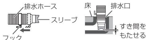
排水ホースは、排水時の水の力や振動などで動く場合がありますので、排水口にしっかり差し込み抜けを確認してください。
