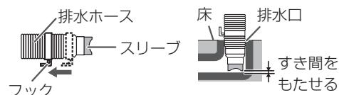
排水ホースは、排水時の水の力や振動などで動く場合がありますので、排水口にしっかりと差し込み抜けないことを確認してください。
