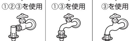
給水栓ジョイント(CB-J6)を取り付けた場合は、付属のマジックつぎ手を使用せず、直接給水ホースを取り付けてください。 → step3
