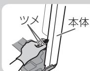
本体の内側から排水口キャップ、排水口リングのツメを強くつまみ、本体の外側に押し出してはずす。
