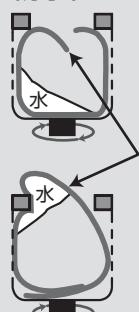
洗濯・脱水槽が回転しても水が防水性の衣類や繊維製品から出られないため、水が片寄って大振動を引き起こす
