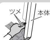
本体の内側から排水口キャップ、排水口リングのツメを強くつまみ、本体の外側に押し出ししてはずす。
