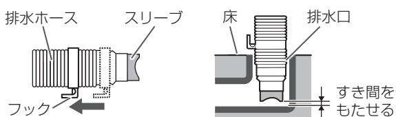
排水ホースは、排水時の水の力や振動などで動く場合がありますので、排水口にしっかり差し込み抜けないことを確認してください。
