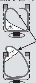
洗濯・脱水槽が回転しても水が防水性の衣類や繊維製品から出られないため、水が片寄って大振動を引き起こす
