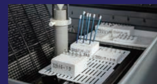
ネジ腐食損傷試験
