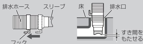
排水ホースは、排水時の水の力や振動などで動く場合があるため、排水口にしっかり差し込み抜けないことを確認してください。
